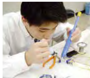
慎重に、慣れた手技でスイッチにハンダ付け
